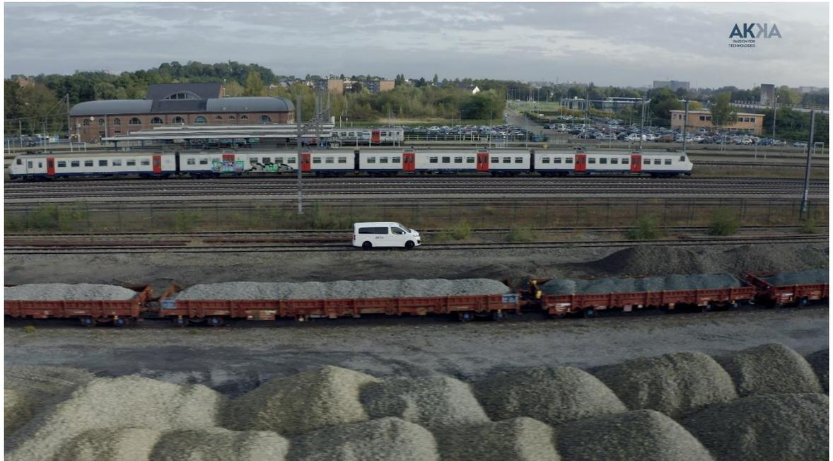
*La Ferromobile, véhicule rail-route au cœur du projet Flexmove, roulant sur les rails d'une ligne de test en Belgique*
