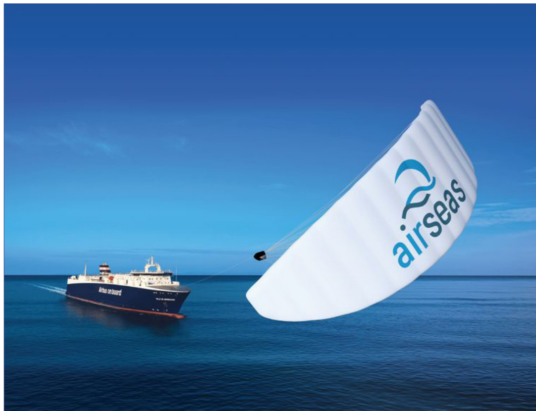
Figure n°21 : La voile « Seawing » de 500 m 2 tractant le cargo « Ville de Bordeaux », de Louis Dreyfus Armateurs.
