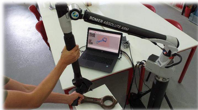
Scan laser : scan, retro-conception et contrôle
